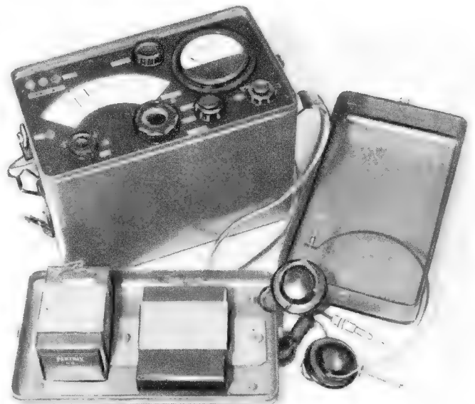
Bild 9. Das Testgerät mit den in den Boden eingebauten Batterien
